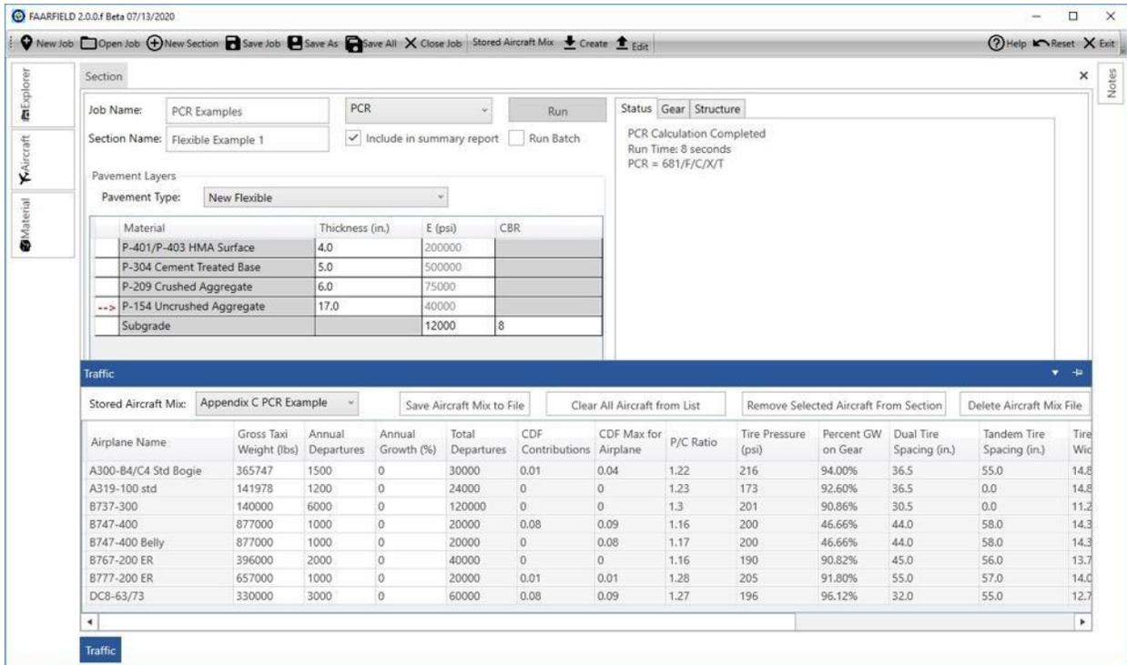
**Figura B-6. Tabla de tráfico FAARFIELD: ejemplo flexible 1 (valores ACR)**
