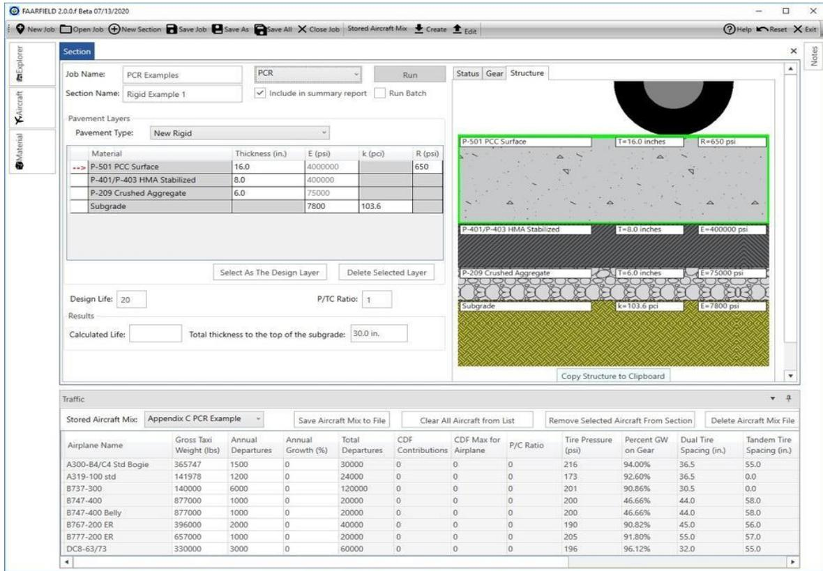
Figura B-19. Salida FAARFIELD PCR – Ejemplo rígido 1
