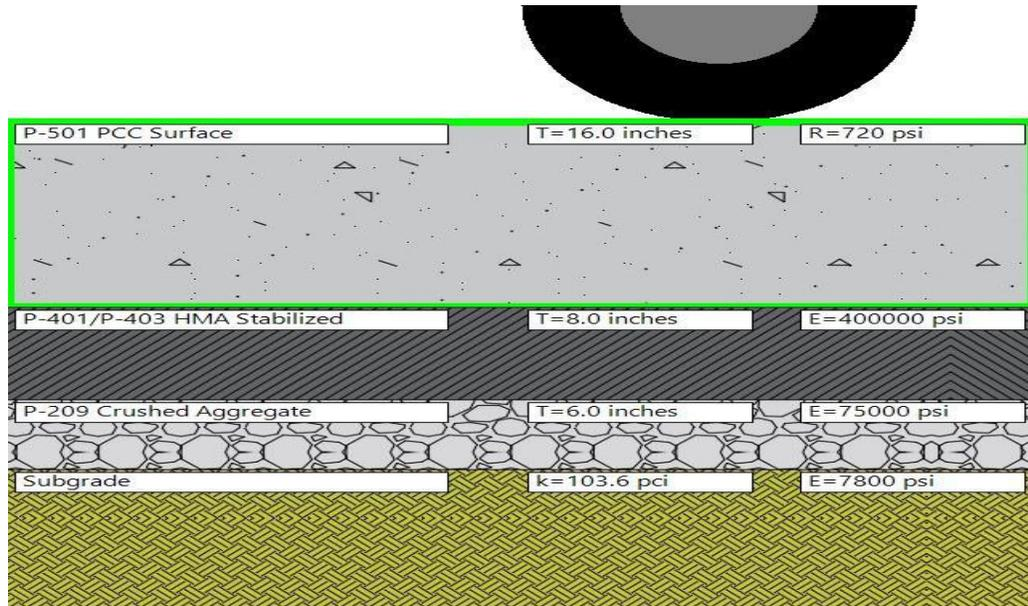
Figura B-24. FAARFIELD Gráfico PCR– Ejemplo rígido 2
