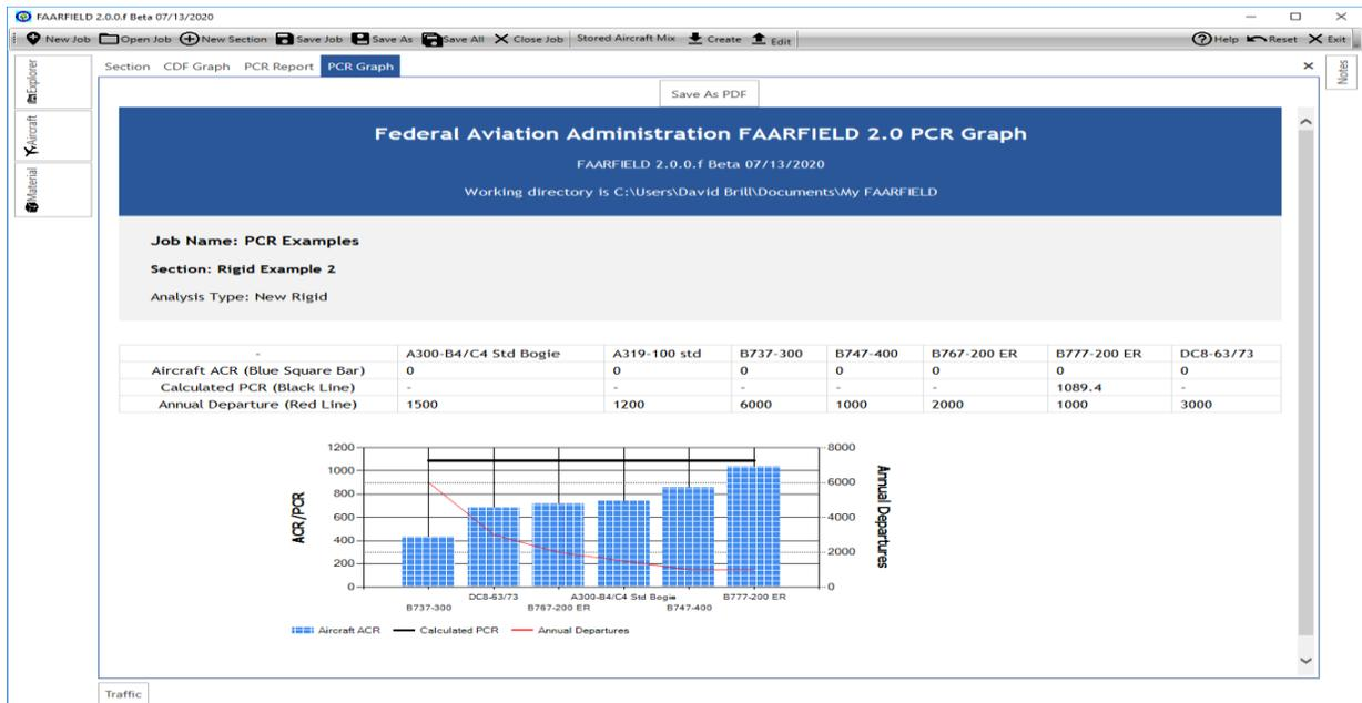
**Figura B-25. Informe DE PCR DE FAARFIELD – Ejemplo rígido 2**
