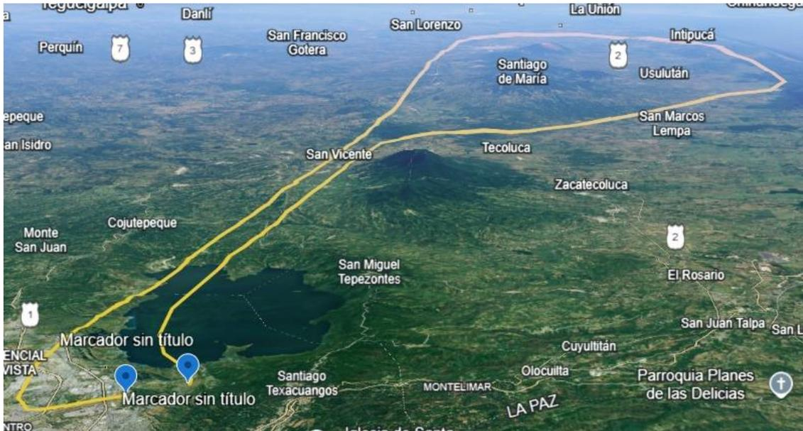
Durante el trayecto de sobrevuelo cerca de Puerto Barillas, el piloto al mando notó un ligero aumento en la temperatura del aceite de motor, inmediatamente se comunicó con el servicio técnico en su base de operación y le indicó que retornaría al aeropuerto de salida. Sin embargo, luego de 20 minutos de vuelo y al acercarse al lago de Ilopango, observó un incremento significativo en la temperatura de aceite, a posterior se produjo la detención súbita del motor.
