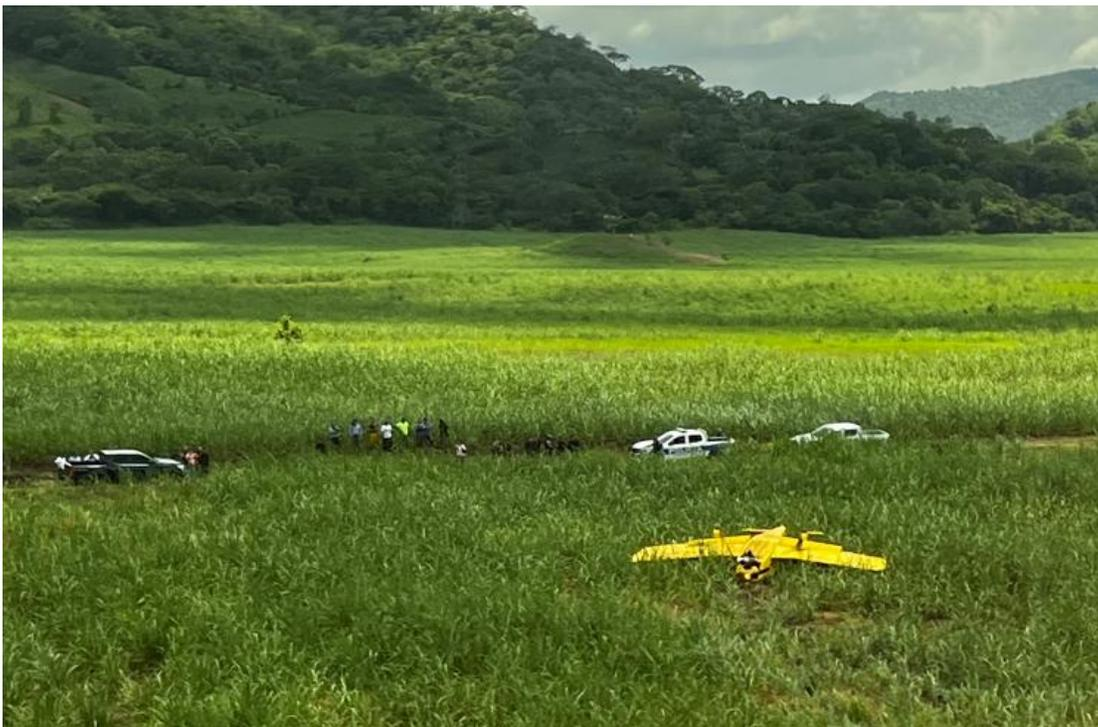
1.3.1 El avión, matrícula YS 289P, sufrió daños estructurales al quedar invertido, parabrisas roto
