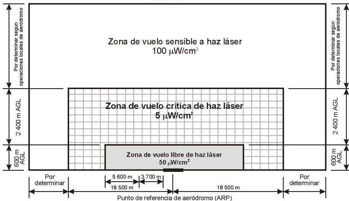
Figura E-13. Zonas de vuelo protegidas indicando los niveles máximos de irradiación para rayos láser visibles
